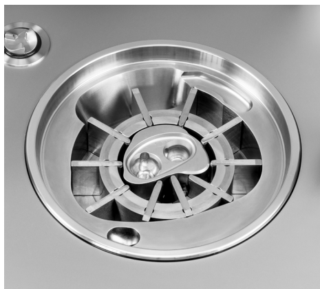
Rotor de paletas de la VF 818 S
