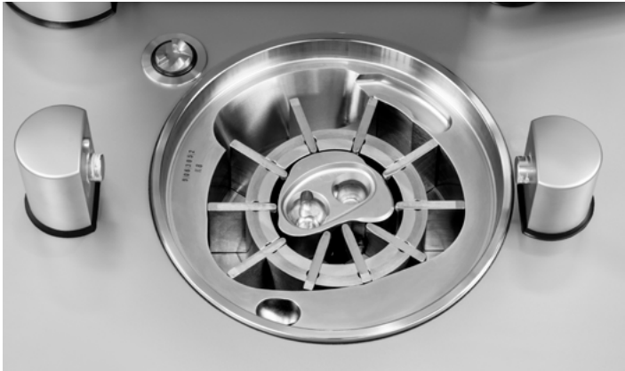
Rotor de paletas de la VF 806 S
